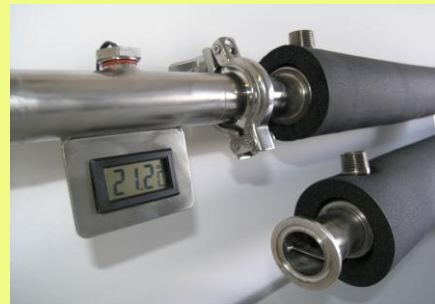
Bild 18: Eingebaute Temperaturmessstelle. Wenn nur eine Messstelle eingesetzt wird, sollte die am Ende des Kühl-systemes kurz vor dem Eintritt in den Milchtank verbaut werden
