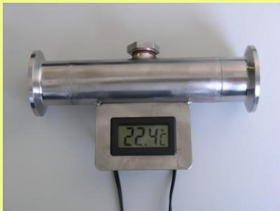
Bild 17: Temperaturmessstelle. Kann an jeder beliebigen Stelle eingesetzt werden
