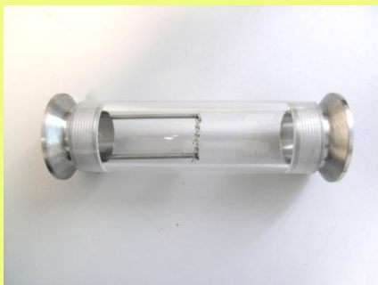
Bild 19: Schauglasarmatur mit Vorfilter. Sollte bei Bedarf vor der ersten Kühlstrecke verbaut werden. Filtersieb gibt es in verschiedenen Feinheiten und lässt sich leicht entnehmen und reinigen
