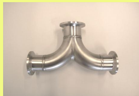
Bild 20: Verteiler / Sammelstück. Zum Aufteilen / Zusammenführen auf mehrere Parallelstrecken. Bei großen Milchmengen und Milchleitungen ab DN 40 um den Milchfluss aufzuteilen und somit die Kühlleistung zu erhöhen
