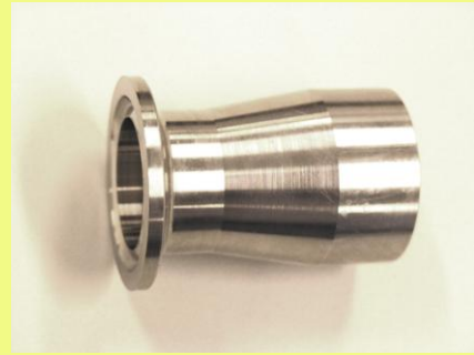
Bild 08: Übergangsstück von bestehender Milchleitung auf das Schumacher Klemmsystem. Ist für alle auf dem Markt befindlichen Milchleitungsabmessungen lieferbar. Zum Anschweißen oder in längerer Form zum Verbinden mittels Silikonmuffe
