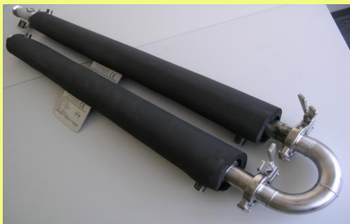
Bild 03: Aufbaubeispiel in Form einer Rohrschlange zur Wandmontage. Kann in mit beliebig vielen Einzelstrecken in jeder Länge durchgeführt werden. Die Austrittshöhe sollte etwas höher liegen als der höchste Füllstand im Milchtank
