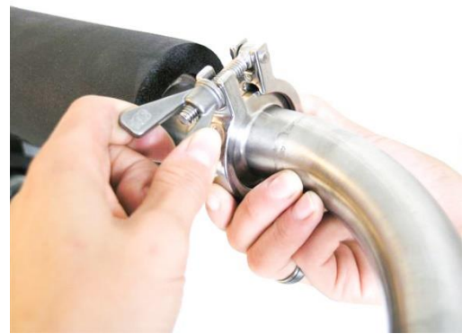
Bild 12: Verschließen der Klammer
