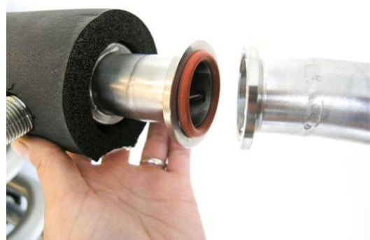
Bild 10: Zusammenfügen der Rohre
